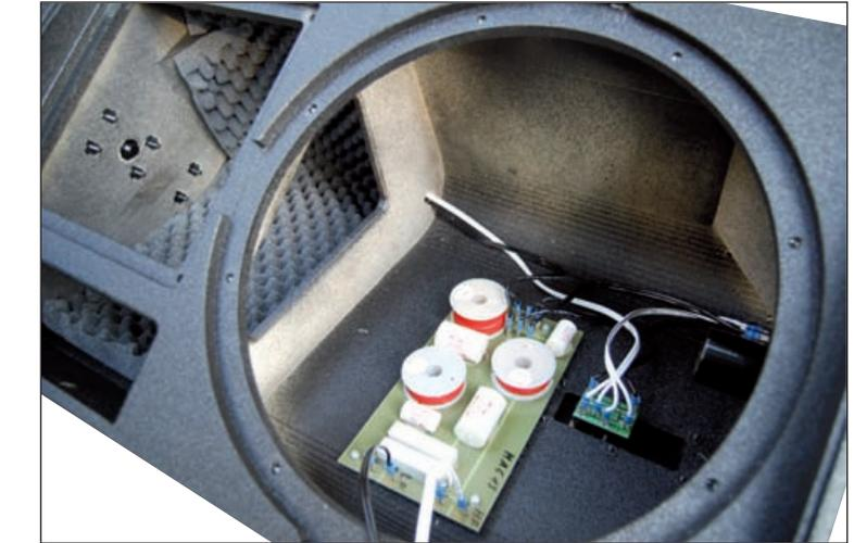
**Abb 3:** Blick in das geöffnete Gehäuse mit Sicht auf einen umlaufenden Versteifungsgürtel, die passive Frequenzweiche sowie die stellenweise genuteten und mit Kleber verfüllten Seitenwände, die so die Gehäuseform der „Magnus 15“ mit den großen Kantenradien möglich machen (das Dämpfungsmaterial wurde für das Foto teilweise entfernt)
