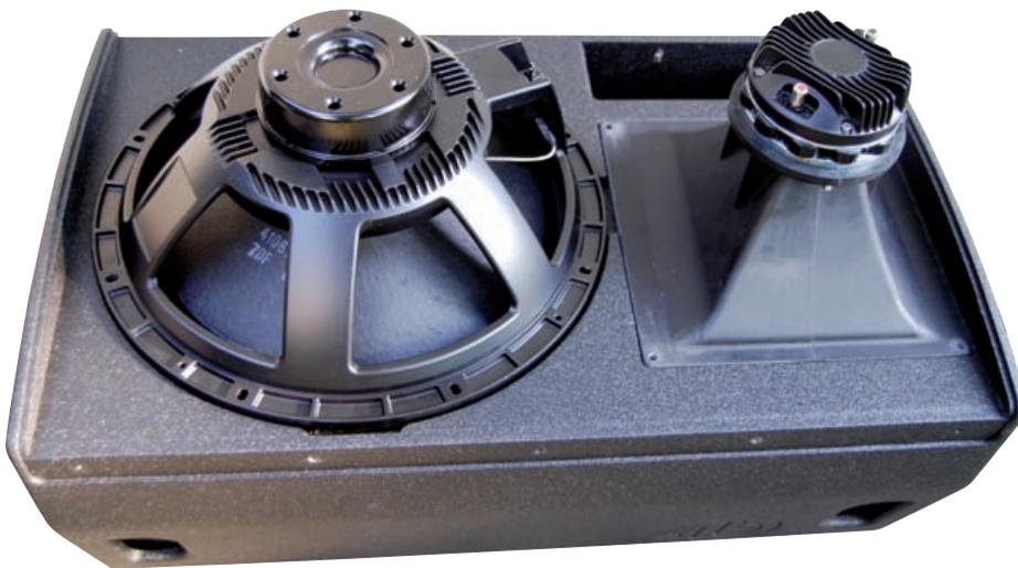
**Abb 4:** Lautsprecherbestückung in der Rückansicht – Tieftonchassis von RCF und Hochtonkompressionstreiber von EighteenSound, beide mit leichten Neodymmagneten
